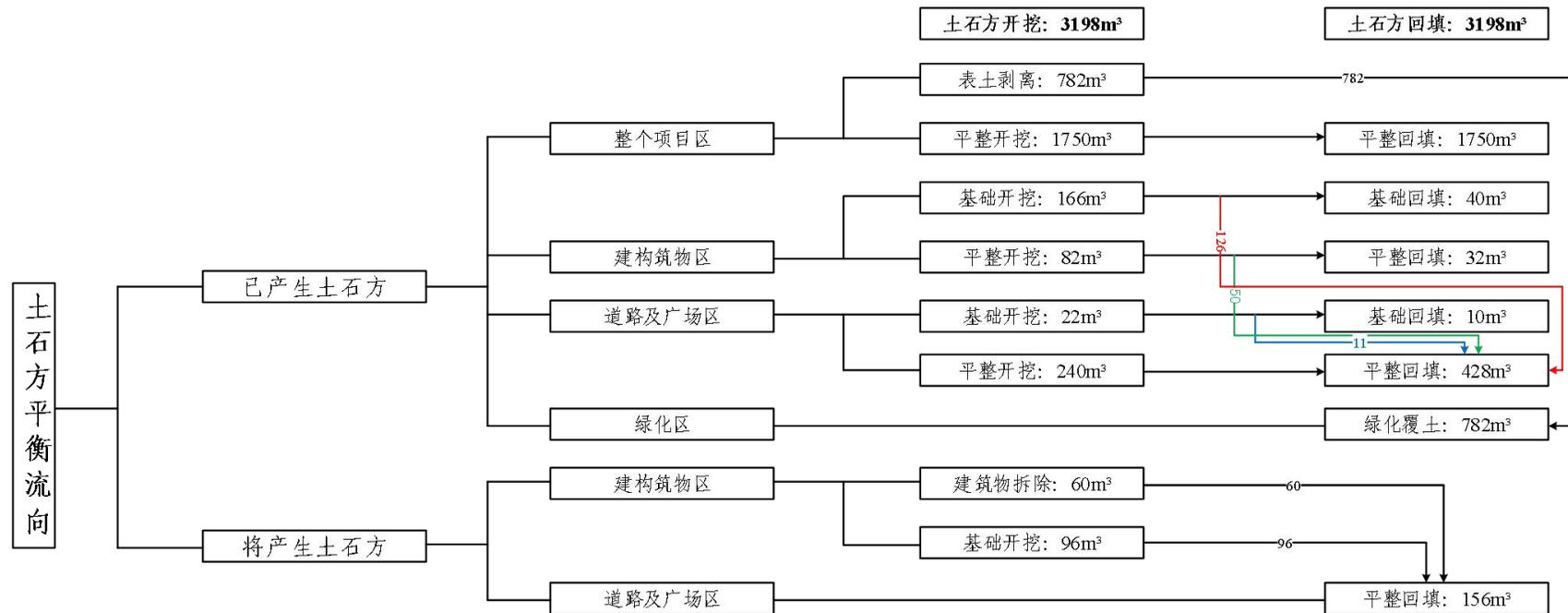
图 2-2 工程土石方平衡及流向图
